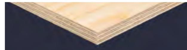
Il multistrato è composto da sovrapposizioni di sottili fogli di legno che vengono incollati tra loro con le fibre poste in senso alternato: si ottiene così un pannello strutturale robusto adatto a varie lavorazioni.
